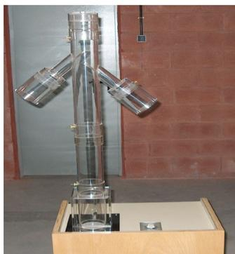
**Figura 30. Columna densimétrica.**
