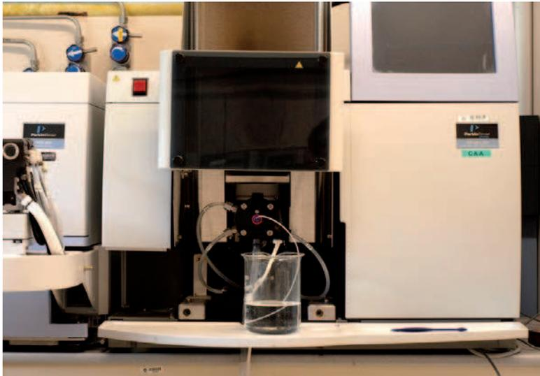
Espectrofotómetro de absorción atómica para determinación de K, Ca, Mg, Na y Al
