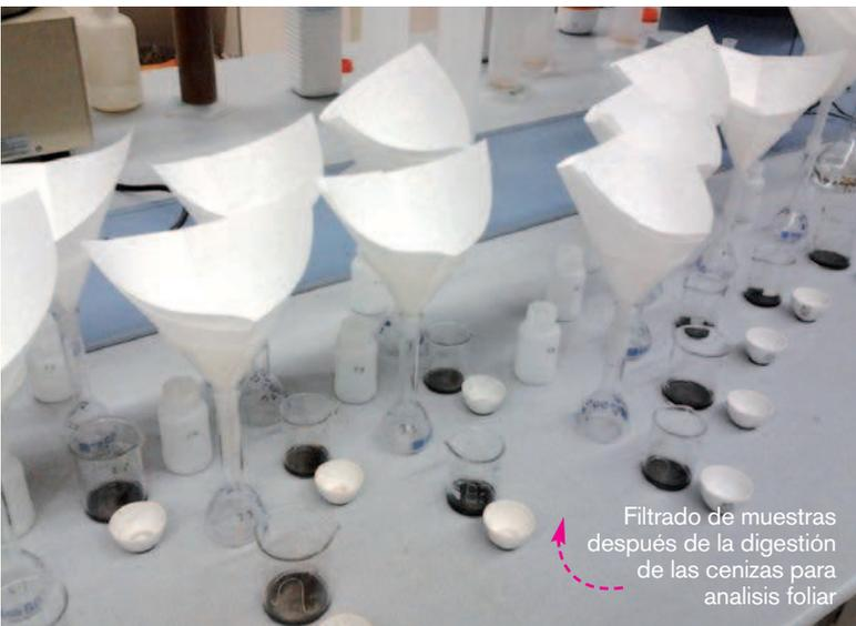
Filtrado de muestras después de la digestión de las cenizas para análisis foliar
