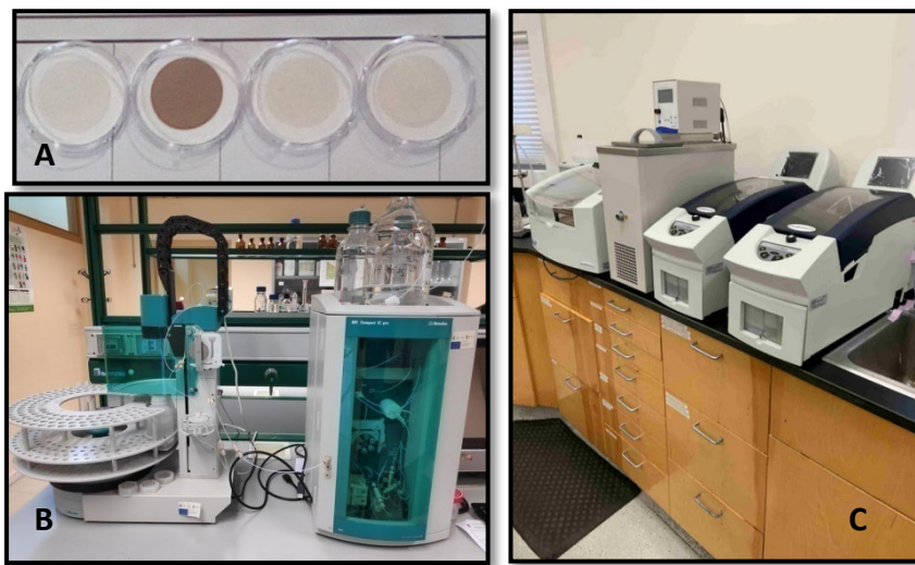
Figura 5. A) Filtros correspondientes a distintas muestras de Ordesa. B) Analizador de Flujo Continuo AMS Alliance Futura 3, Alliance Instruments del IGME. C) Cromatógrafo Iónico 881 Compact IC Pro-Anion, Metrohm del IGME.
