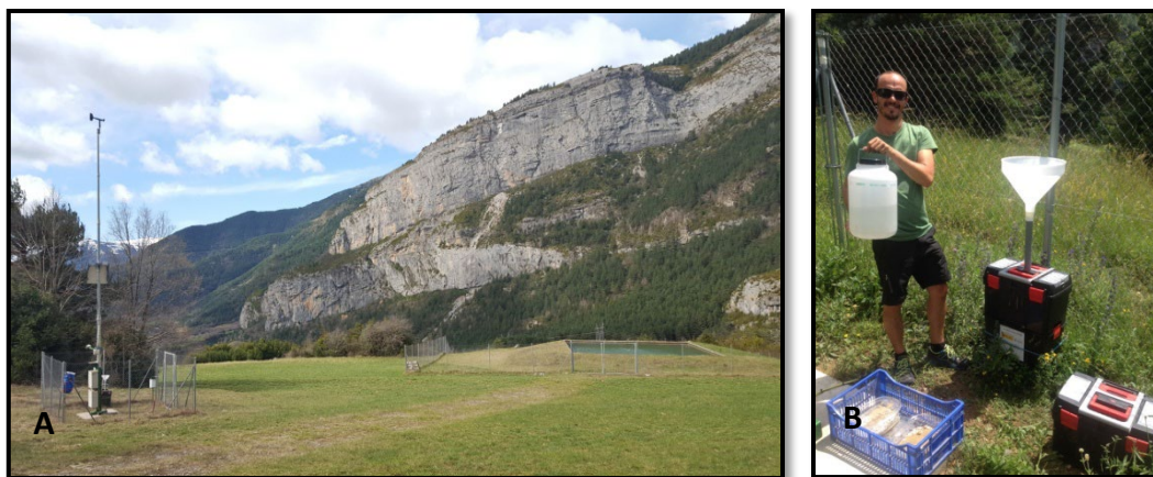
Figura 4. A) Panorámica del emplazamiento donde se sitúa la estación meteorológica “Torla-Ordesa Parque Nacional” y el colector de deposición. B) Dispositivo de recolección de depósito atmosférico, en el que se ve el contenedor opaco, conectado al embudo de la parte superior y el recipiente de 10 litros.
