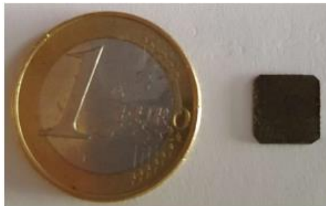
Figura 2.6. Comparativa del tamaño de una probeta SPT 10x10 mm 2
