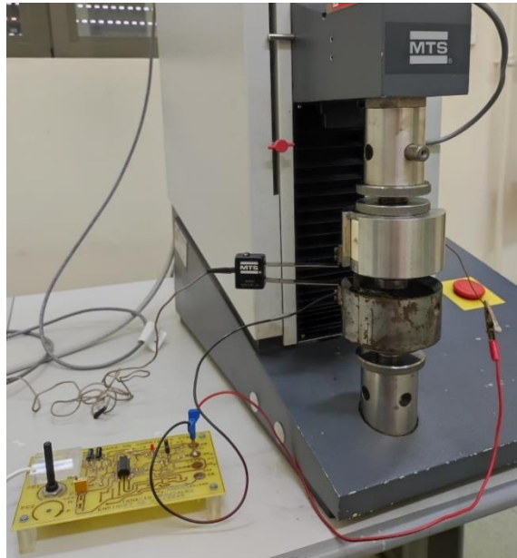
Figura 5.2. Montaje para la realización del ensayo SPT insitu con sus partes
