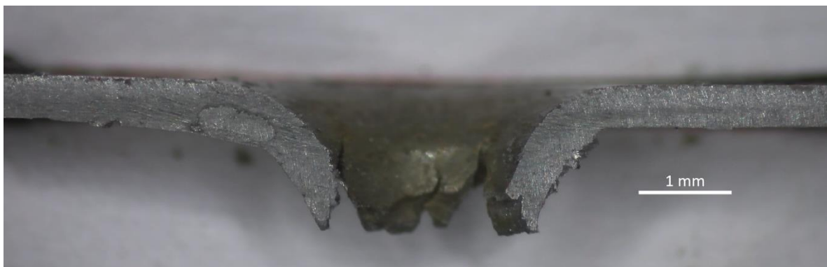
Figura 5.11. Sección transversal de la probeta SPT tras ensayo insitu de CrMoV-BM
