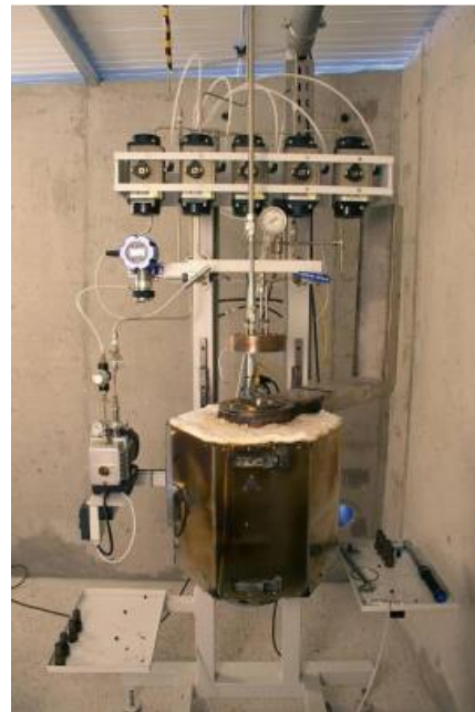
Figura 2.4. Reactor de hidrógeno de la Fundación Idonial [3]
