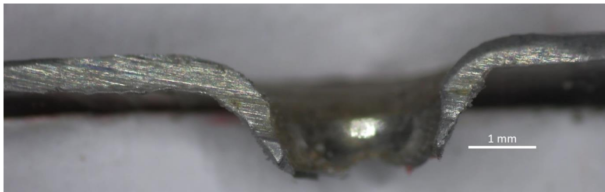
Figura 5.29. Sección transversal de la probeta SPT tras ensayo insitu de S355
