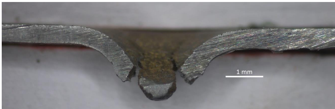
Figura 5.17. Sección transversal de la probeta SPT tras ensayo insitu de R5
