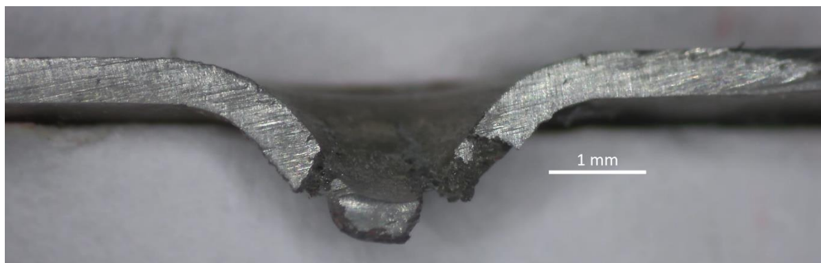
Figura 5.20. Sección transversal de la probeta SPT tras ensayo insitu de R6
