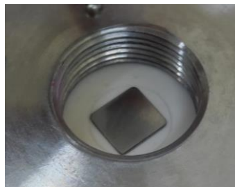
Figura 4.2. Situación de la probeta SPT en la máquina de ensayo una vez lijada
