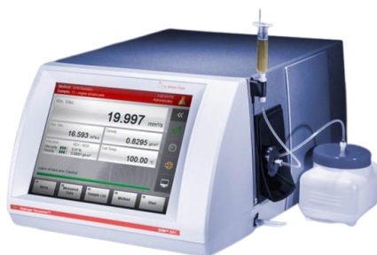
Figura 8. Viscosímetro de alta precisión rotacional Stabinger SVM 3001 [16].
