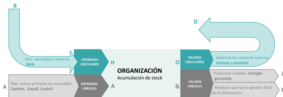
Ilustración 15 Diagrama de Sankey del flujo de materia en la hipótesis de generación convencional
