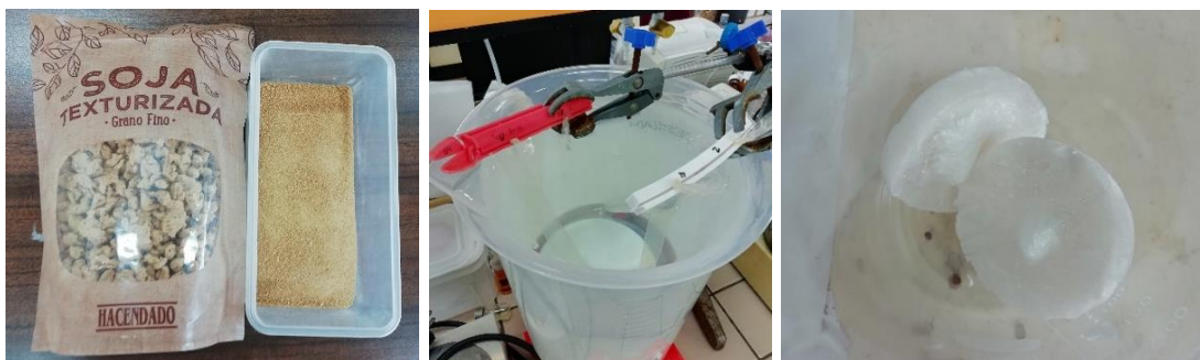
Figura 14 a) Soja texturizada y harina de soja triturada, b) Diálisis de las proteínas de soja y c) Proteínas aisladas de soja (SPI).
