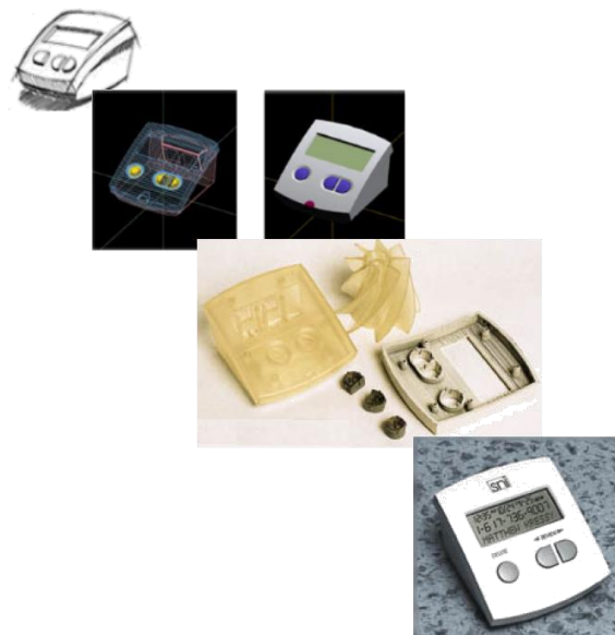
Figura 17. Rapid prototyping process (Kalpakjian, S., & Schmid, S. R., 2014)
