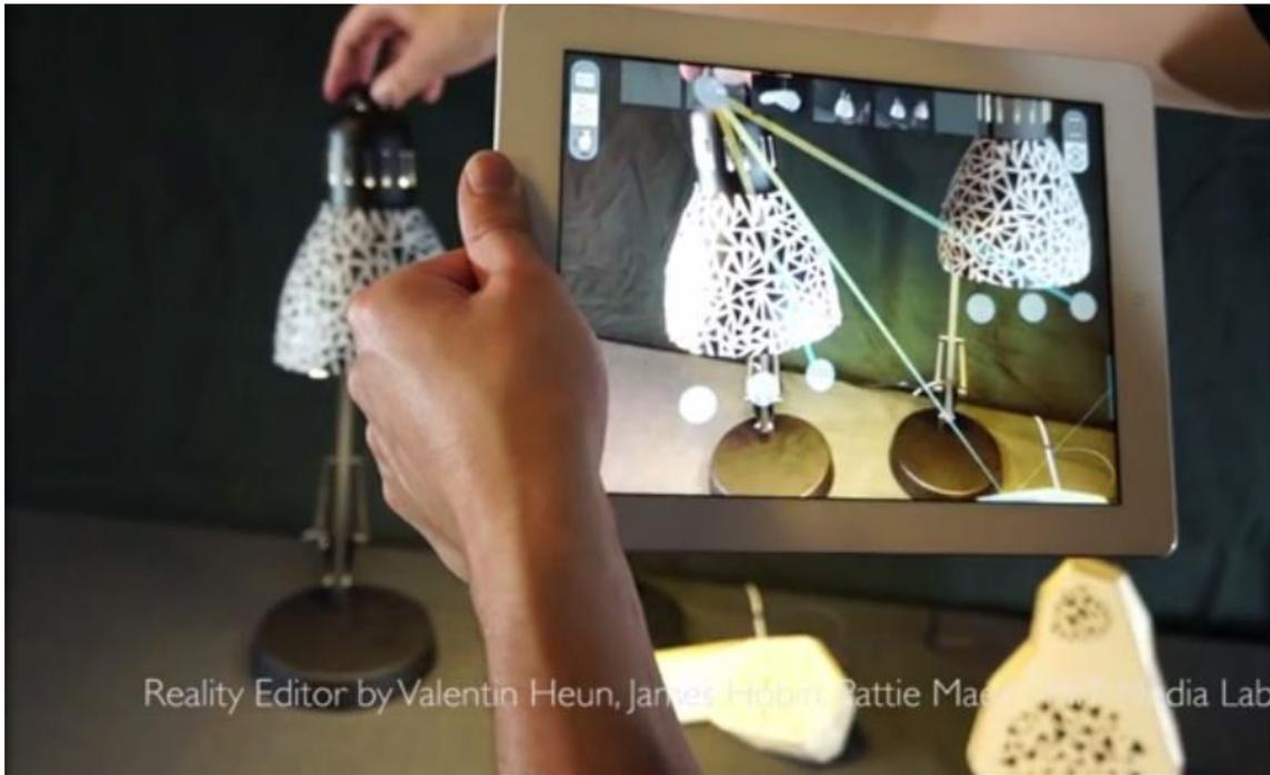
En el mismo ejemplo, mediante la interfaz gráfica, el usuario puede cambiar el color de la lámpara en un selector de colores que se muestra en la pantalla cuando esta se detecta desde la cámara.
