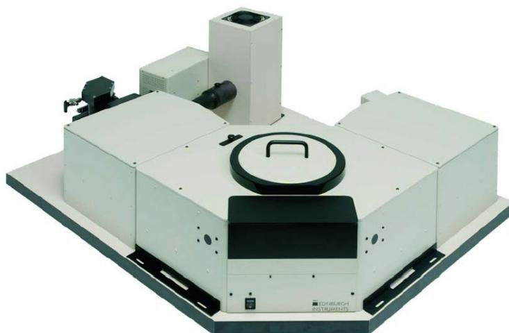
**Figura 4:** Aspecto que presenta el espectrofluorímetro modelo FLSP 920
