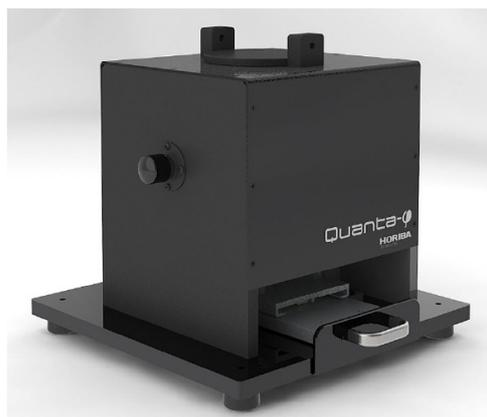
**Figura 8:** Aspecto exterior que presenta una esfera integradora de radiación<sup>10</sup> situada fuera de un espectrofluorímetro
