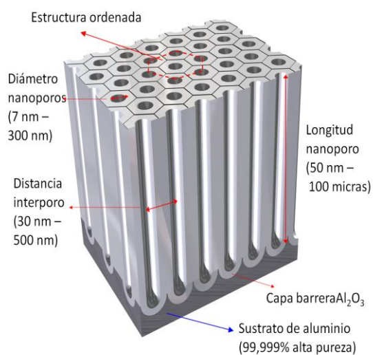
Figura 3. Película de alúmina nanoporosa con sus diferentes parámetros característicos
