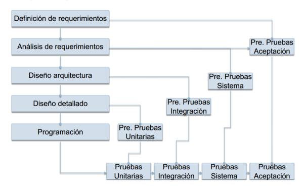
Figura 11 – Modelo de Ciclo de Vida en V detallado
