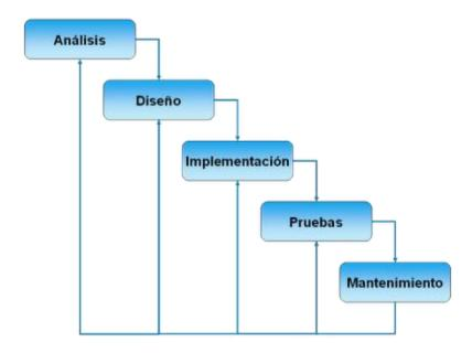
Figura 9 – Modelo de Ciclo de Vida en Cascada Modificado
